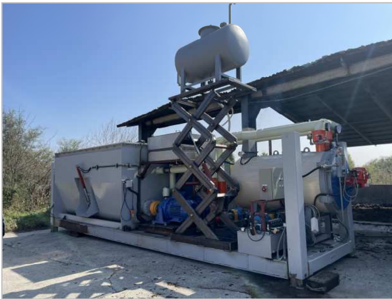
그림 2 이동식 열처리 장비 설치
