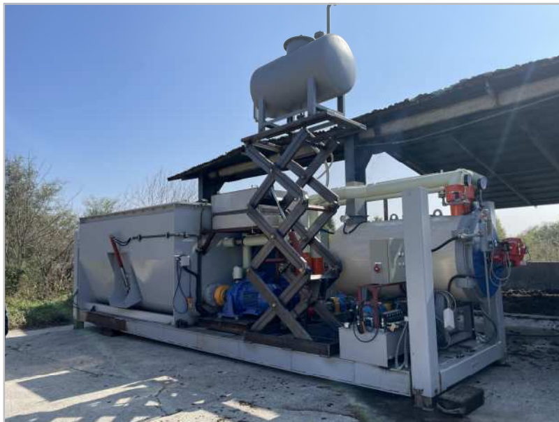
그림 2 이동식 열처리 장비 설치
